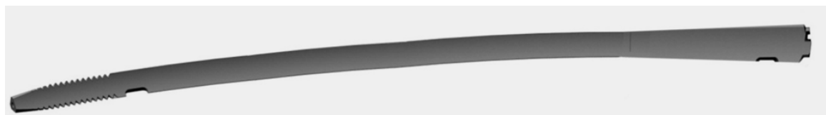
Рис. 2. Изометрическая модель трехреберного стержня «BNB» по патенту РФ № 2526242
