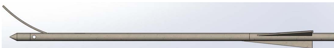
Рис. 1. Изометрическая модель стержня СарНИИТО по патенту РФ №115646
