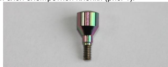
Рис. 1. Внешний вид формирователя десны, покрытого электретом.
