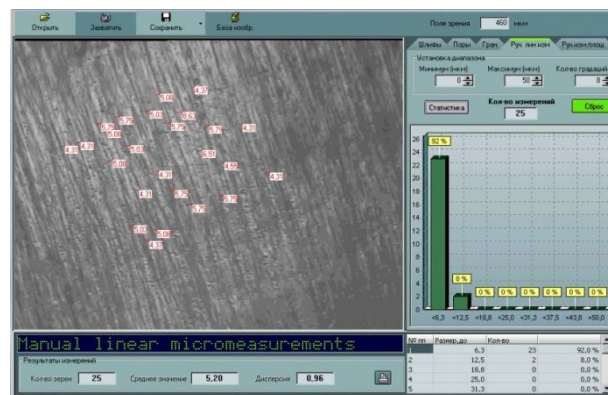
Рис. 5. Эмаль зуба после обработки 20-гранным твердосплавным бором и Enhance (ширина кадра 700 мкм)
